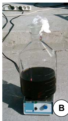
Figura 3.2: Cinética de la desaparición del diclofenaco por fotólisis, y evolución del COT durante el experimento. A) Disolución recién preparada de diclofenaco en agua. B) Disolución al final del experimento.
