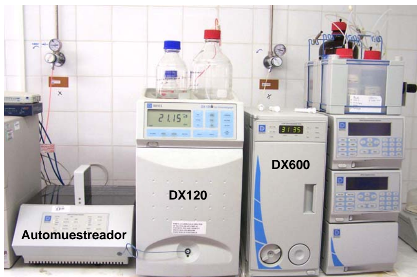
Figura 2.6: Sistema de IC Dionex utilizado. DX120 (cationes), DX600 (aniones/ácidos orgánicos) y automuestreador.
