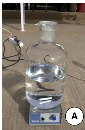
Figura 3.2: Cinética de la desaparición del diclofenaco por fotólisis, y evolución del COT durante el experimento. A) Disolución recién preparada de diclofenaco en agua. B) Disolución al final del experimento.
