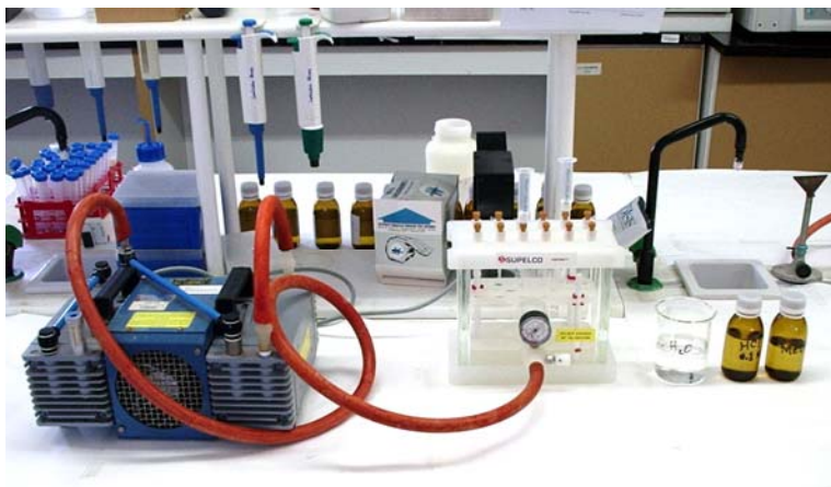
Figura 2.9: Sistema utilizado para la pre-concentración de muestras con SPE.
